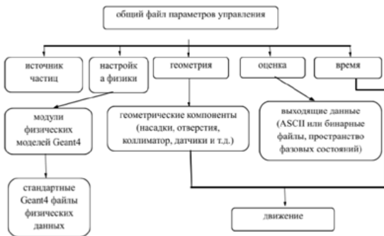
Рис. 1. Иерархическая структура системы моделирования 4 (Ibid., p. 981).
